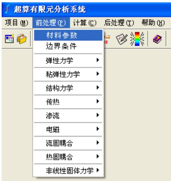
图 5-3-2 选择材料参数输入
