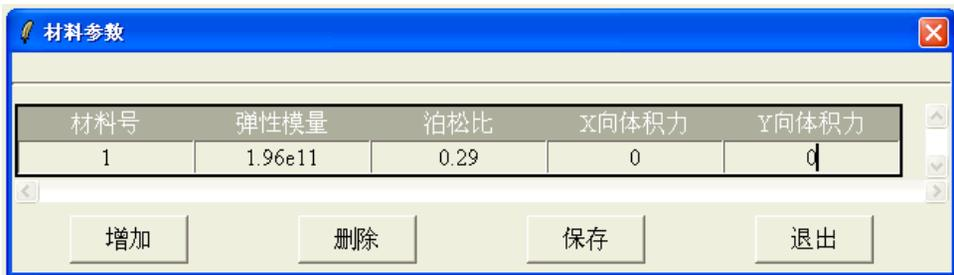
图 12-4-5 填写完成材料数据输入
