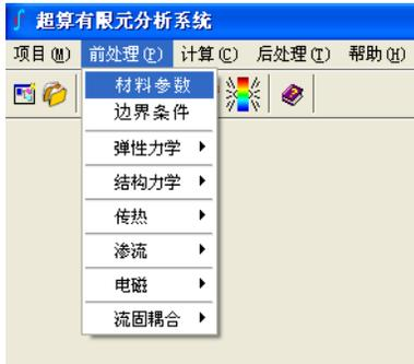
图 6-2-3 选择材料参数输入
