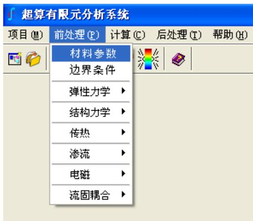
图 1-3-2 选择材料参数输入
