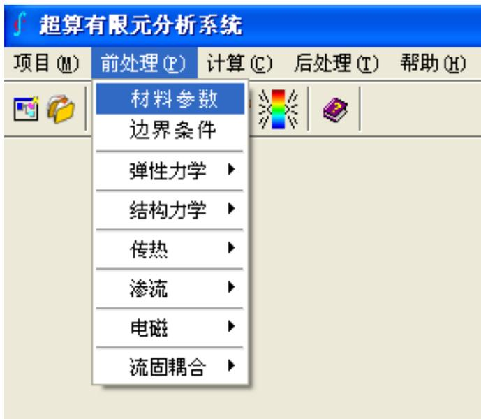
图 1-1-2 选择材料参数输入
