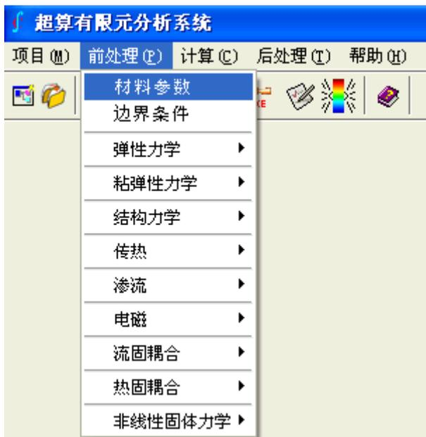
图 12-1-3 选择材料参数输入
