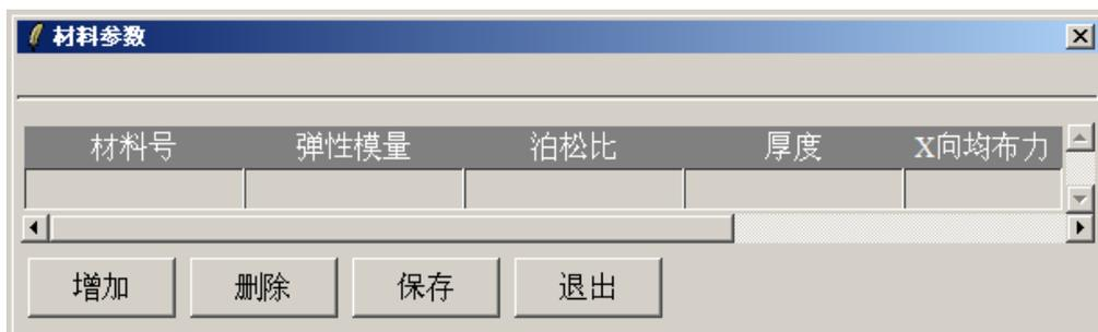
图 9-4-4 材料参数输入对话框
