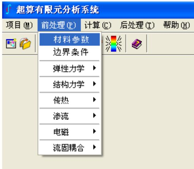
图 8-1-3 选择材料参数输入
