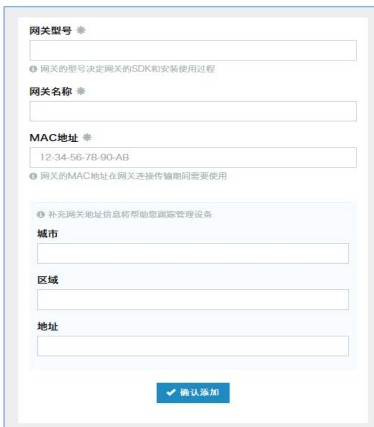
添加网关页面中，必选项包括：网关型号，输入网关名称和网关 MAC 地址。其中网关型号和 MAC 地址必须根据实际情形填写，否则网关无法正确连接 LoRaCube。
