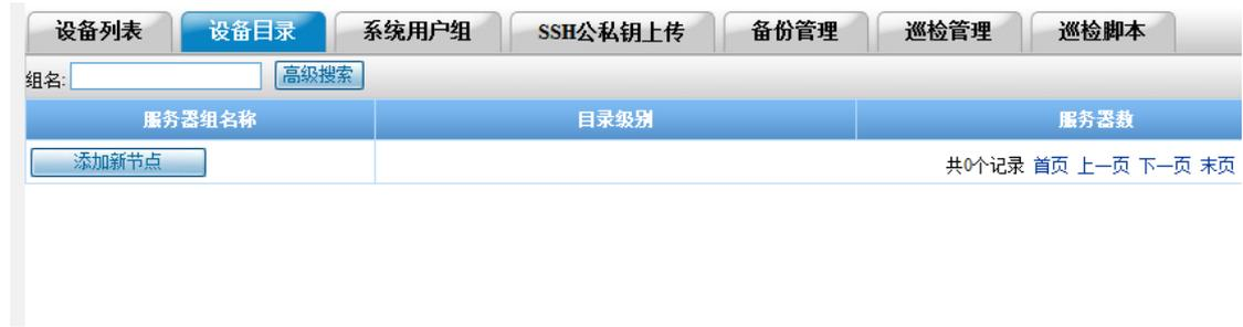
点击添加，可以添加设备目录节点，设备目录节点可以分为一级节点、二级节点、设备组三个级别，其中二级节点必须属于一个一级节点
