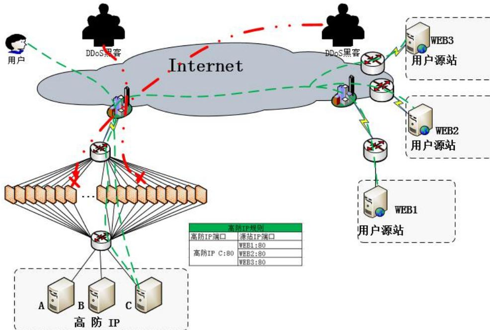
1. 高防 IP 对应多个用户源站，实现源站负载均衡。当源站池中所有源站不可用时，自动启用备用源站。
