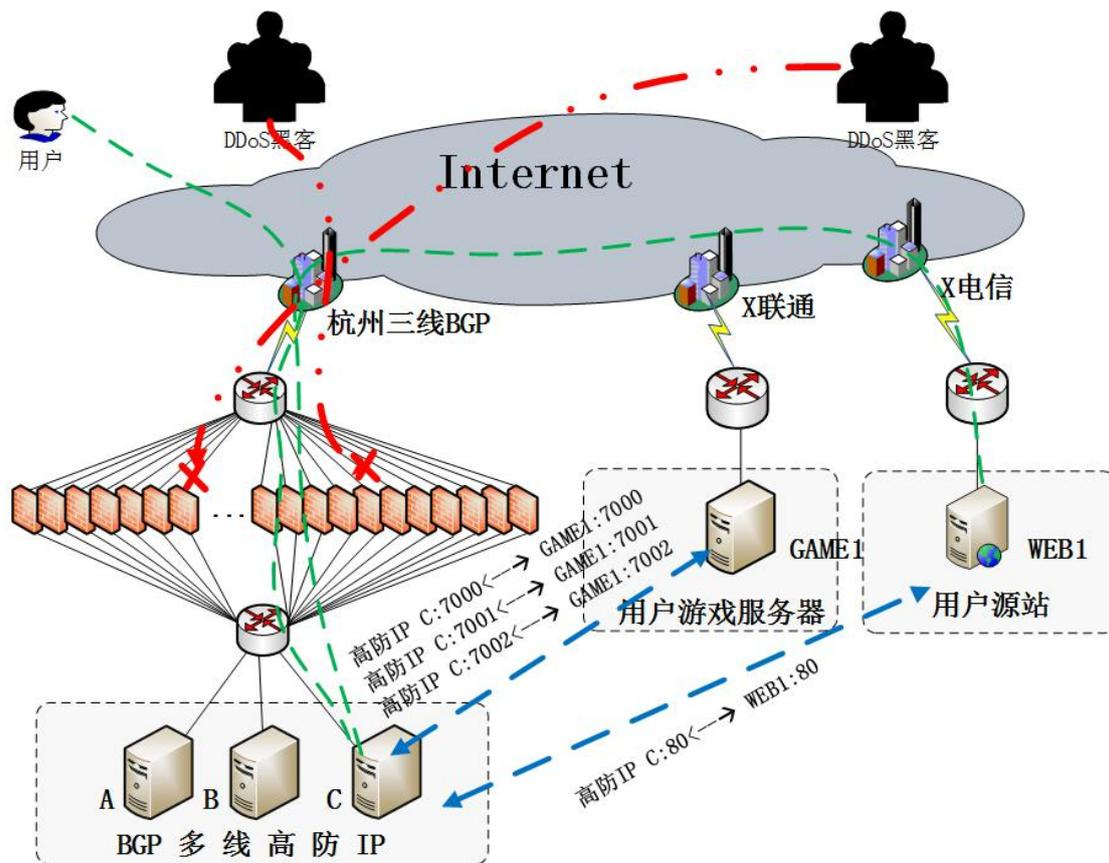
部署在多线机房的高防 IP，可为单链路接入的用户，在提供 DDoS 防护的同时提供加速服务
