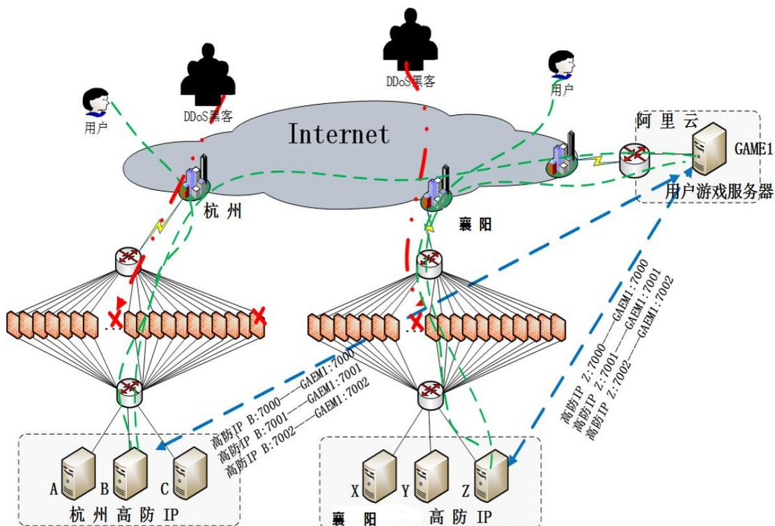
DNS 解析分流，把流量引入不同的高防机房，来过滤大流量，实现阶段、切片清洗。。可实现 DDoS 流量防护叠加和负载均衡。
