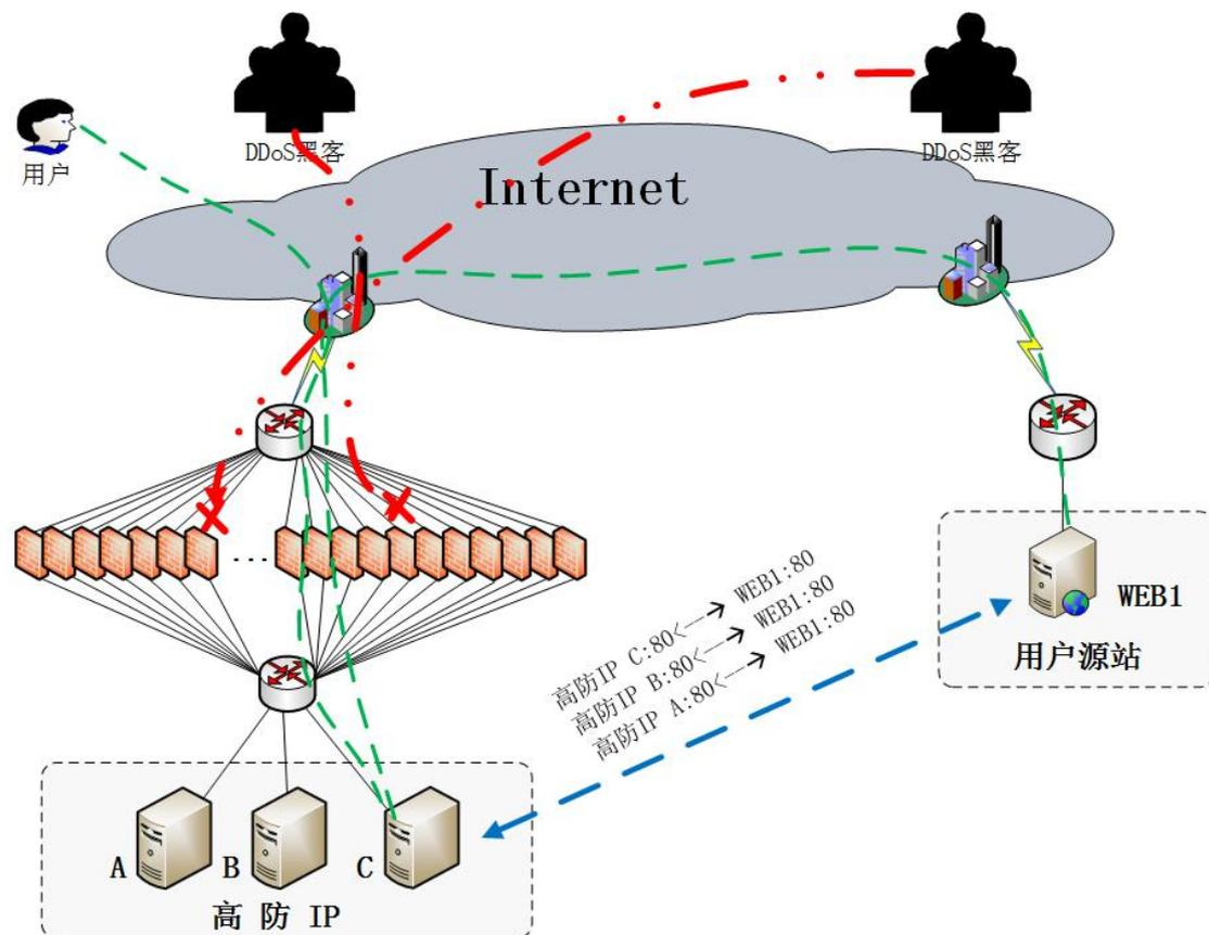
调整 DNS 域名解析或通过直接修改 IP。将公网对源站 (或服务器) 的访问流量, 直接引导到高防 IP 业务地址上。高防 IP 设备前端配置有大容量 DDoS 防护集群, 可对针对高防 IP 的流量攻击和 CC 攻击做完美防护。保障高防 IP 客户业务服务器在不牵移物理位置的条件下, 免受 CC、DDoS 攻击影响
